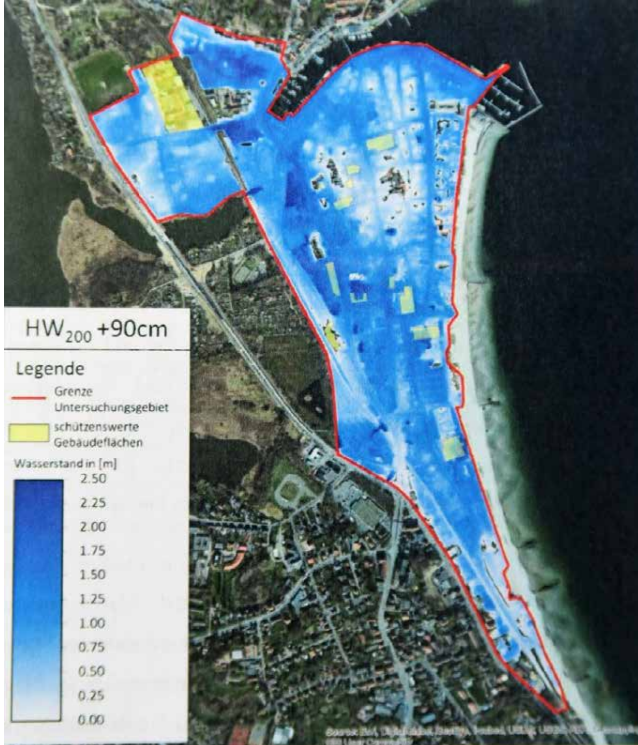
Abbildung 36: Überflutung Eckernförde im Szenario HW 200 +90cm. [nach LVerGeo SH]
